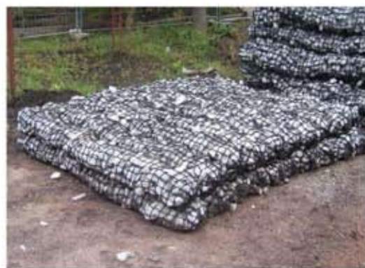
Figure 7 : Gabions tubulaires liés en matelas 2 x 2m
